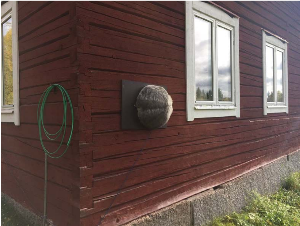
Bild 1. Bild tagen på mätpunkten för ljudtrycksnivå. Mikrofonen är monterad dicht an den standardiserade mätplattan och därefter har det sekundära vindskyddet monterats ovanpå mikrofonen.
