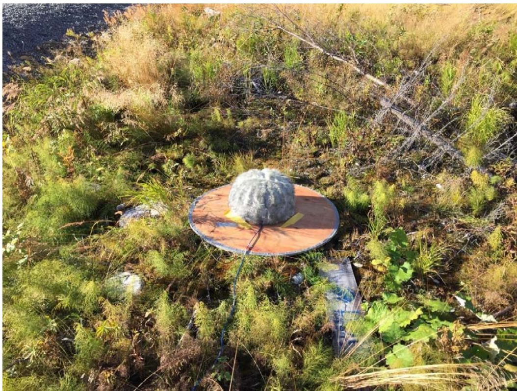
Bild 2. Mikrofon på mätplatta med vindskydd över.
