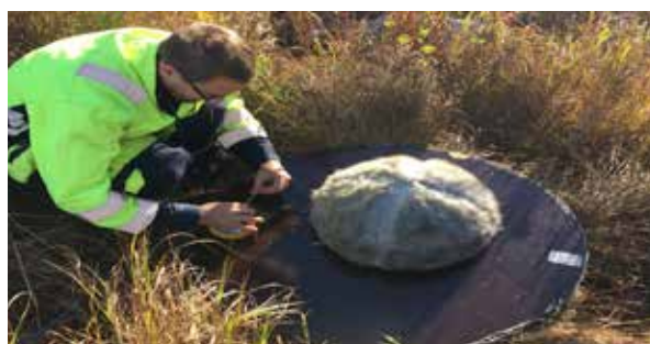
Figur 2 Montering av mikrofon intill vindkraftverk
