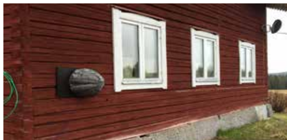
Figur 3 Ljudmätare på fasad hos närboende (Västvattennäset)
